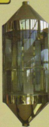
کابین‌های ساخته شده درواحدتولید این شرکت هم از نظر تزئینات داخلی وهم از نظر اسکلت فلزی دارای کیفیت بالایی می باشند. جداره بیرونی کابین ها از ورق فولادی روغنی ۱/۵ میلیمتر و یا استنلس استیل ساخته شده است که به قطعات کوچکتر تبدیل شده و به یکدیگر پیچ و مهره می گردد تا استحکام لازم را داشته باشد. نمای داخل کابین نیز طبق سلیقه و خواسته مشتری به زیباترین شکل ممکن و با بهترین کیفیت بر اساس تکنولوژی و استاندارد روز دنیا ساخته می شود.
